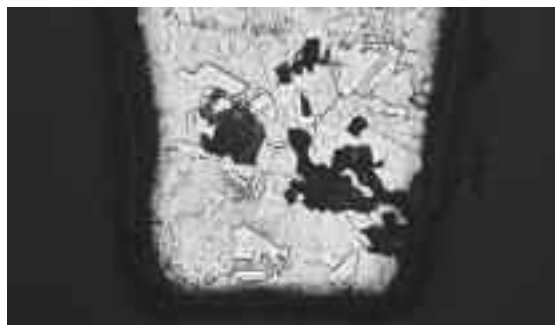
Foto n° 1 - Particolare micrografico (500X) di attacco corrosivo sulla rigatura della superficie interna di un tubicino in rame.
